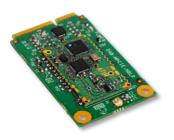
Cette carte se connecte au bus Mini PCI Express et vous permet d'intégrer facilement la technologie Sigfox ou LoRaWAN™ sur vos cartes de développement.
